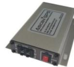
아센코리아의 축적된 기술로 개발된 GNSS 신호 Controller 입니다. 2채널을 지원하며 각 Channel의 독립 제어가 가능합니다. 신호 세기의 조절, On/Off 제어가 가능하며 과전류 감지, 출력단의 High Impedance 분리 설계를 특징으로 합니다. 12V의 사용전원이 가능하도록 설계 되었습니다. Line Noise 감쇠를 보강 하며 신호를 증폭해주는 역할을 담당 합니다.
